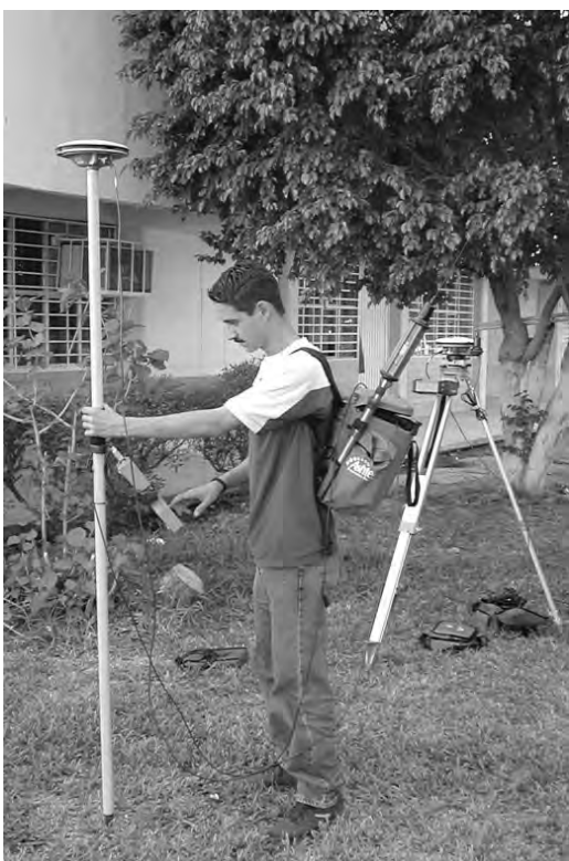
Para la toma de datos geoespaciales se usaron antenas de GPS con aditamentos de RTK.
